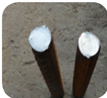
مقطع برش خورده آرماتور با دستگاه برش پنیری
