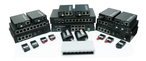
光纤收发器,是一种将短距离的双绞线电信号和长距离的光信号进行互换的以太网传输媒体转换单元,在很多地方也被称之为光电转换器(Fiber Converter)。产品一般应用在以太网电缆无法覆盖、必须使用光纤来延长传输距离的实际网络环境中,且通常定位于宽带城域网的接入层应用;如:监控安全工程的高清视频图像传输;
