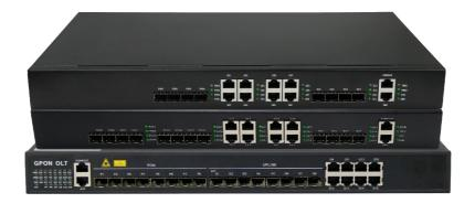
EPON OLT是一款高集成度和中等容量的盒式OLT,专为运营商的接入和企业园区网络而设计。 遵循IEEE802.3 ah技术标准,满足YD / T 1945-2006接入网技术要求的EPON OLT设备要求 - 基于以太网无源光网络(EPON)和中国电信 EPON技术要求3.0。EPON OLT系列具有优良的开放性,大容量,高可靠性,完整的软件功能,高效的带宽利用率和以太网业务支持能力,广泛应用于运营商前端网络覆盖,私网建设,企业园区接入等接入网建设。
