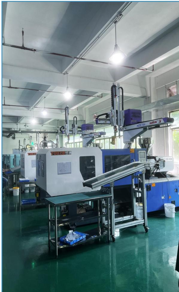
拥有先进的各种型号成型机台30余台，吨位由80T至150T。
