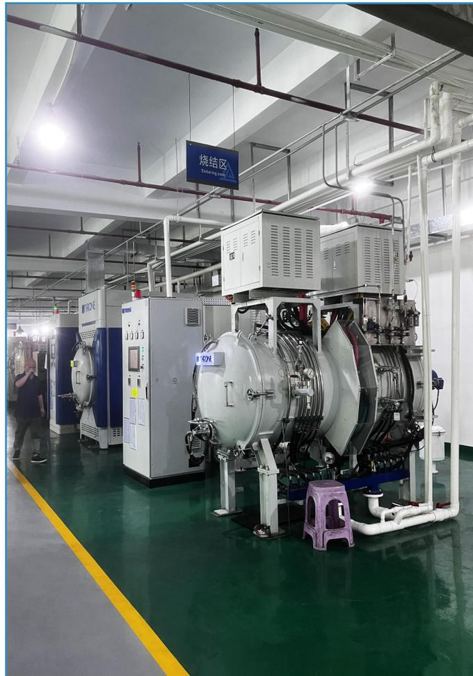
拥有先进的石墨热场真空脱脂烧结炉，用于产品的热脱和烧结。适和烧结铁镍合金、大部分不锈钢（304L、316L、17-4Ph、420、PANACEA等）。
