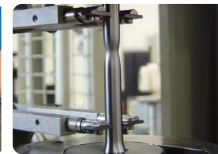
Steel Tensile Test ◆ 钢材拉伸试验 ◆
