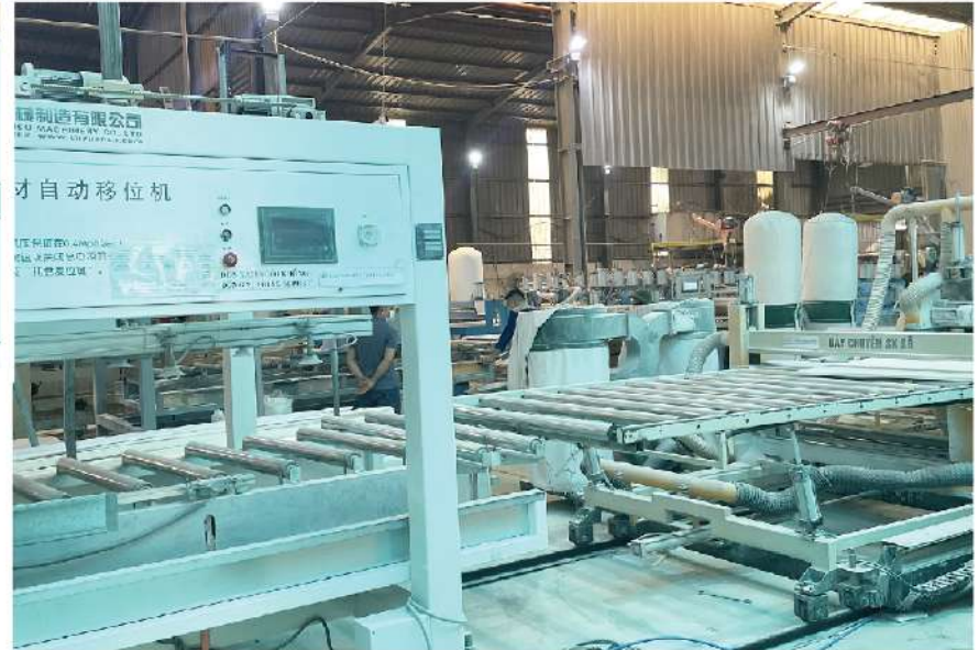
02 DÂY CHUYỀN SẢN XUẤT TẤM VÁN GỖ NHỰA PHỦ MẶT PVC VÂN GỖ Production line of PVC boards covered with wood grain film
